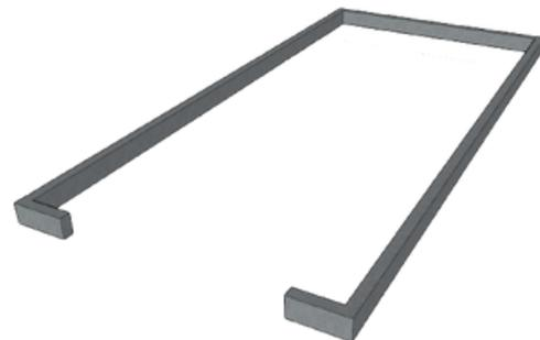
**1** À l'aide d'un mètre ruban, et avant de commencer le montage du garage, mesurez et contrôlez les dimensions de la dalle béton. Mesurez la largeur (Axe 1), la longueur (Axe 2) puis les diagonales (Axes 3). Si les dimensions ne sont pas exactes, partagez les dimensions en plus ou en moins
