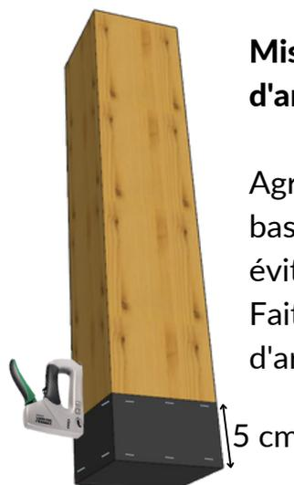
Mise en place de la bande d'arase sur les poteaux 12 x 12.
