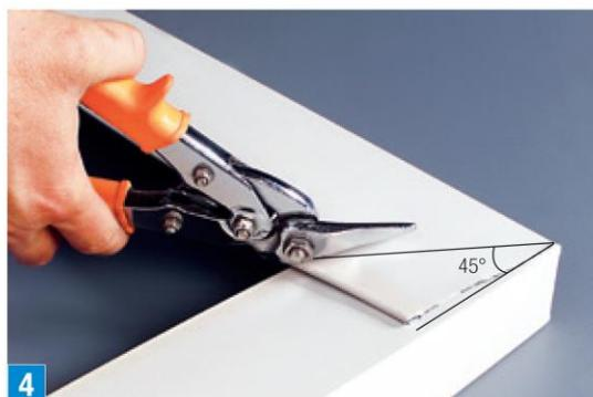
4 Replier jusqu'à former un angle de 90° et couper la tôle à 45° en superposition comme indiqué sur la photo.
