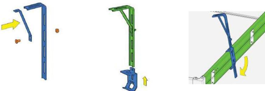
Assembler les suspentes puis les clipper sur les rails.
